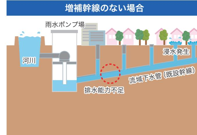
寝屋川流域の雨水ポンプ場・既設流域下水管は、都市化の進展による雨水流出量の増大により現在、おおむね3年に1度の大暴雨に対応できません。したがってそれ以上の豪雨の時にはポンプ場・下水管の排水能力が不足し、浸水発生の危険性が高くなります。
